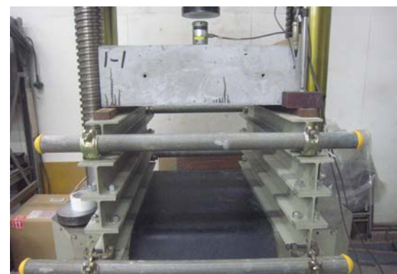
写真-3 押抜き試験状況
