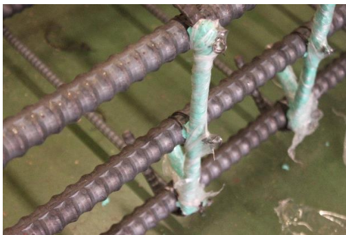
写真-1 せん断補強筋の付着を切った部分
