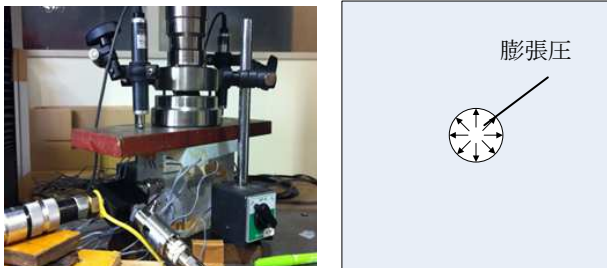
(1) 荷況状況 (2) 荷方向概要 図-2 膨張圧荷荷の状況 (モルタル供試体)
