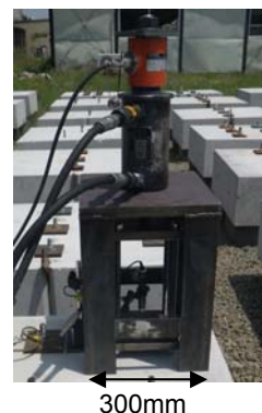
図-5 引抜き試験装置
