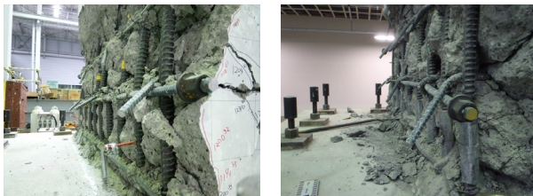
写真-2 直角フック曲げ戻し状況 (左: WN, 右: WJH)
