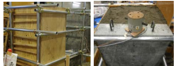
写真-2 土槽の設置および振動試験状況
