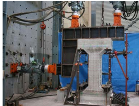
図-1 荷重装置を設置した試験体の全景
