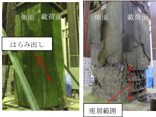
(a) はらみ出し状況 (b) 試験終了後 図-6 L1 試験体破壊状況
