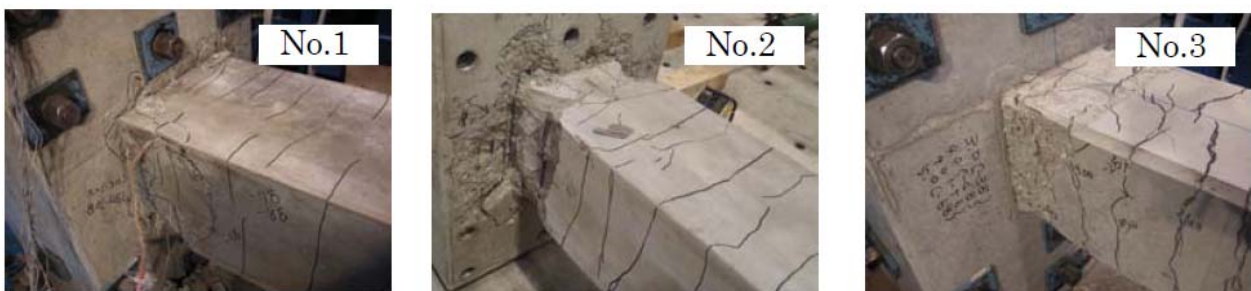
図-9 基部の破壊状況
