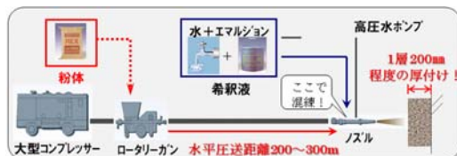
図-2 乾式吹付けモルタルの混練システム
