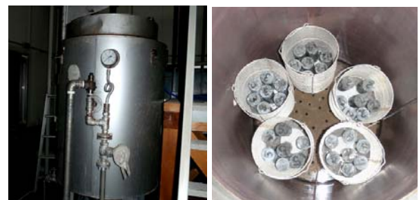
写真-4 オートクレーブ養生の状況
