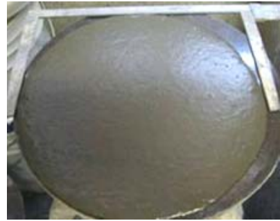
写真-2 モルタルフロー試験の状況
