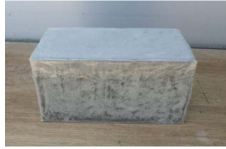
写真-2 養生フィルムによる封かん状況
