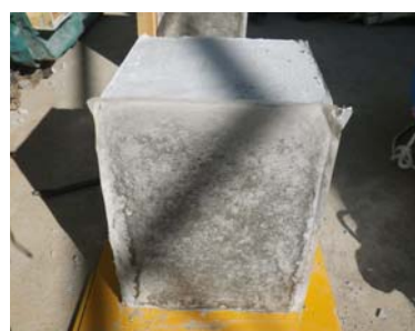
写真-6 脱枠時フィルム状況 (ケース 2)
