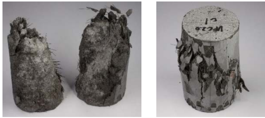
(a) T-CPC-2 (b) B-CPC-2 写真-1 供試体の圧縮破壊性状の一例
