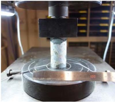
写真-1 φ33mm 小径コア圧縮強度試験状況
