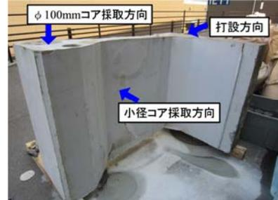
シリーズ D 試験体 (PC 橋 T 桁切出し部材)
