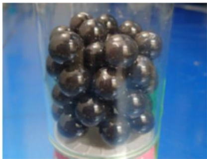
図-2 実験に使用した14.288mmのセラミック球
