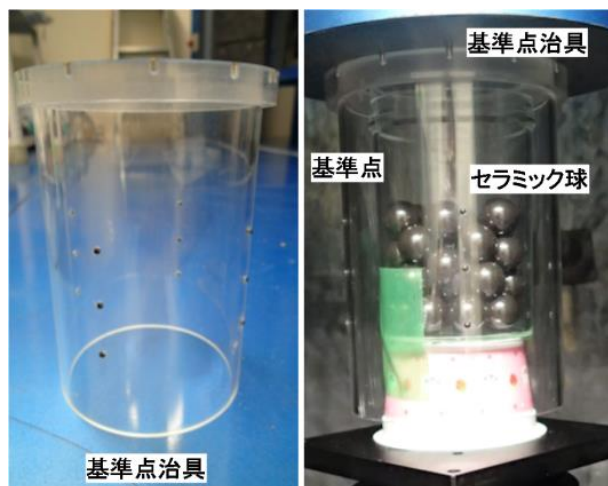
図-12 基準点のための治具と設置した様子
