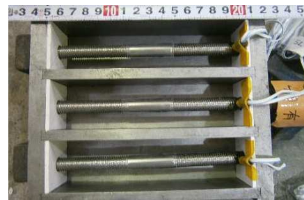
写真-2 モルタル供試体概要 (改良試験法)
