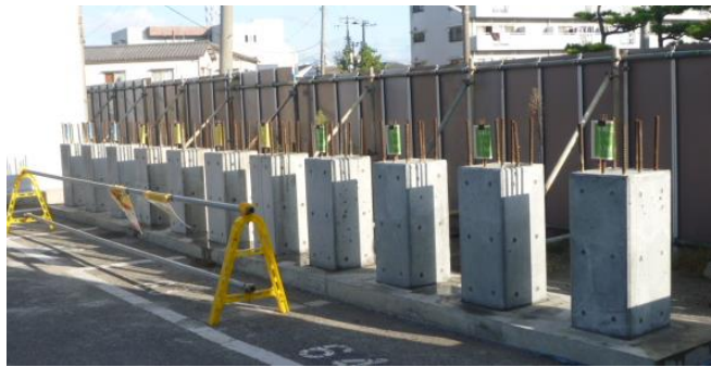
a) 角柱試験体暴露状況
