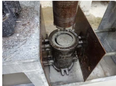
写真-4 コア抜きの写真
