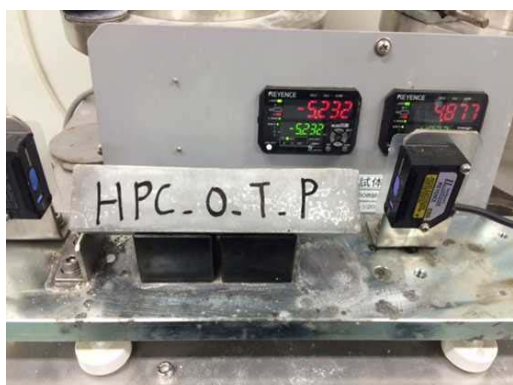
図 - 3 レーザー変位計による長さ変化測定
