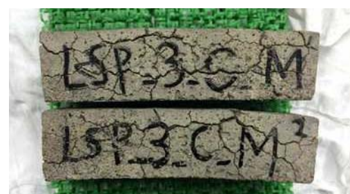
図 - 9 炭酸イオン含有溶液に浸漬させた LSP 配合 (SO 3 を 3% 添加) の表面写真 (左: セメントペースト, 右: モルタル)
