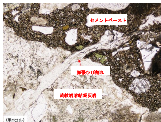
写真-9 事例Ⅳの偏光顕微鏡による観察結果
