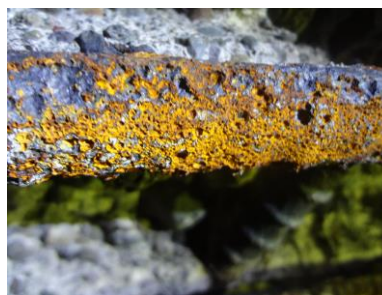
写真-2 分析試料3の孔食
