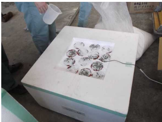
写真-1 簡易断熱養生箱
