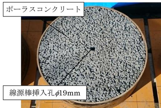
写真-2 削孔後の様子
