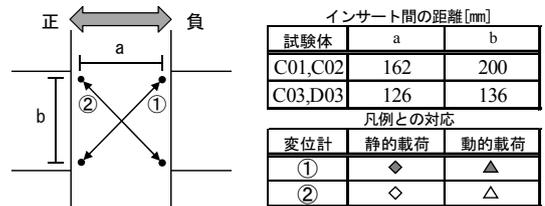
図-9 対角線方向の変位計測
