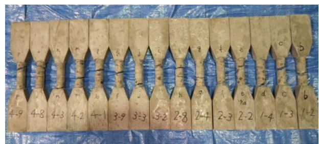
写真-6 引張供試体の破壊状況 (右側より No. 1)
