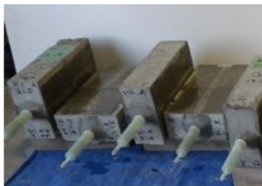
写真-2 注入時のブロック供試体
