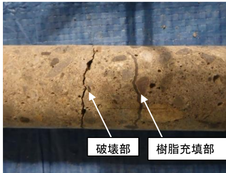
写真-10 25mm コア引張供試体の破壊状況(一例)
