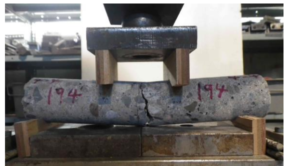
写真-8 曲げ試験状況
