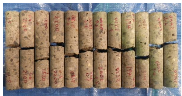
写真-9 50mm コア曲げ供試体の破壊状況 (全体)
