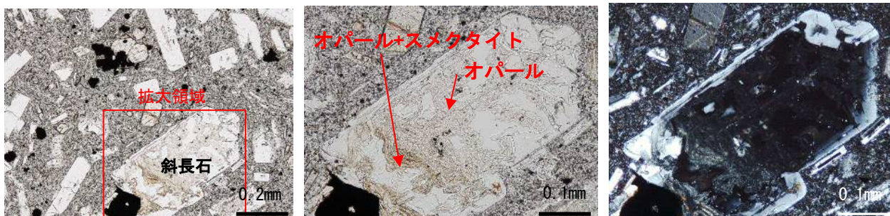
写真-2 偏光顕微鏡によるコア薄片の観察結果 (左, 中央: 単ニコル, 右: 直交ニコル)
