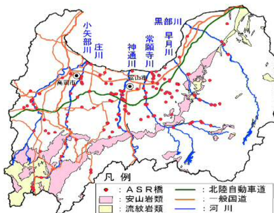
図-1 富山県の地質と ASR 橋の分布状況
