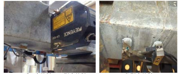
レーザー変位計・ \pi 型変位計 亀裂変位計
