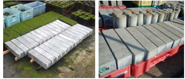
写真-2 海洋環境暴露状況
