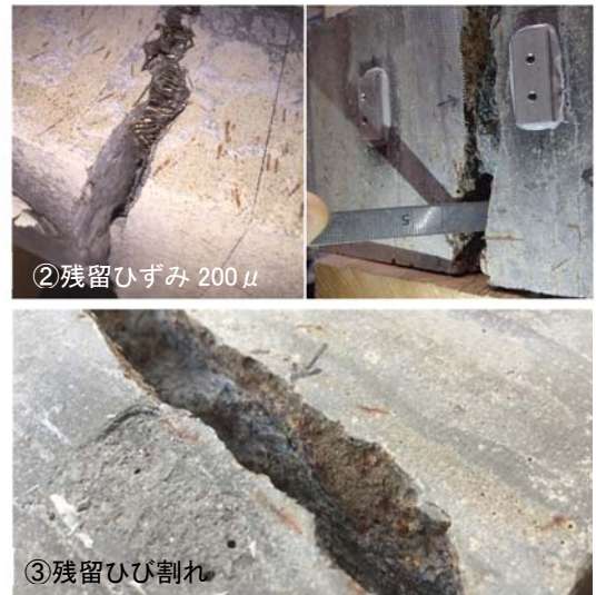
写真-4 曲げ疲労試験後の破壊面
