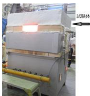
写真—1 耐火試験状況
