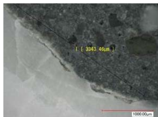
写真-1 セメントペーストと骨材界面の状況 7)
