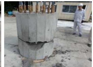
写真 - 20 破砕直後の 状態 (試験体 3)
