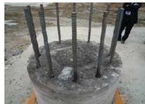
写真-1 破断面の状態
