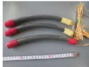
写真 - 17 動的破砕剤 + 点火具 (試験体 3)
