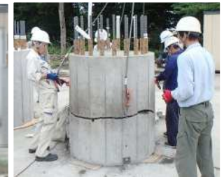
写真-8 破碎直後の 状態（試験体1）
