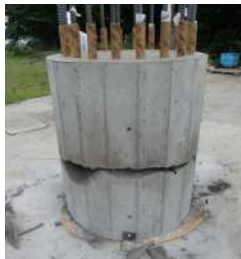
写真 - 14 破砕直後の 状態 (試験体 2)
