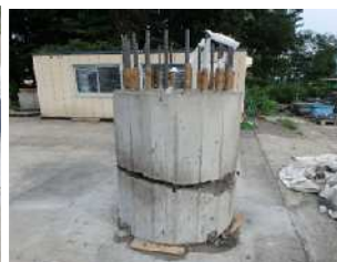
写真 - 26 破砕直後の状態 (試験体 4)
