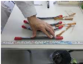
写真 - 23 動的破砕剤 + 点火具 (試験体 4)
