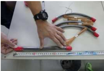
写真 - 11 動的破砕剤 + 点火具 (試験体 2)
