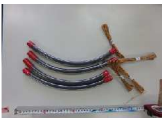
写真-3 動的破碎剤 + 点火具（試験体1）
