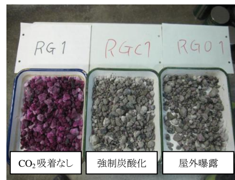
写真-1 フェノールフタレイン溶液による着色状況
