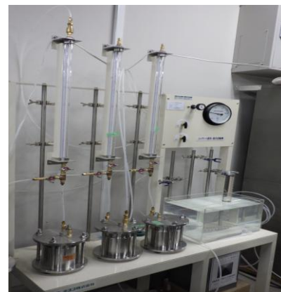
写真-2 透気試験装置
