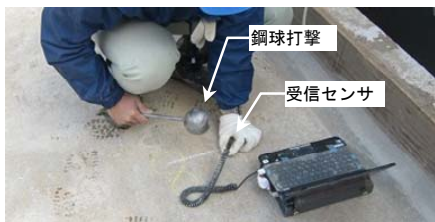
写真-1 部材厚さの測定
