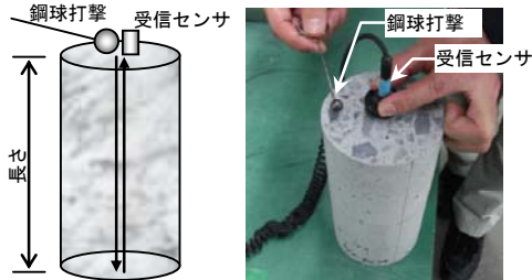
図-3 円柱供試体での弾性波伝搬速度の測定
