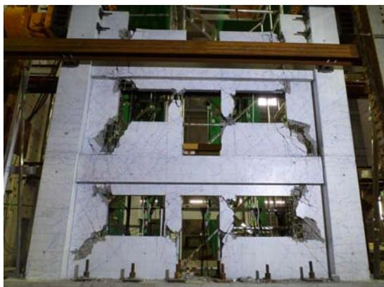
写真-1 壁付き架構の3%加力終了時の破壊状況
