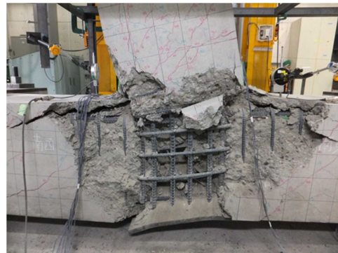
写真-1 接合部の損傷状況 (T5 実験終了)
