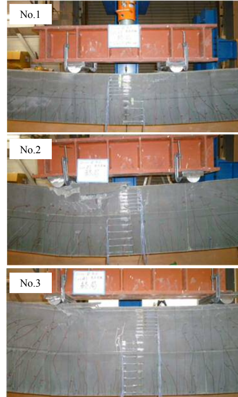
写真-1 各ケースの曲げ破壊状況
