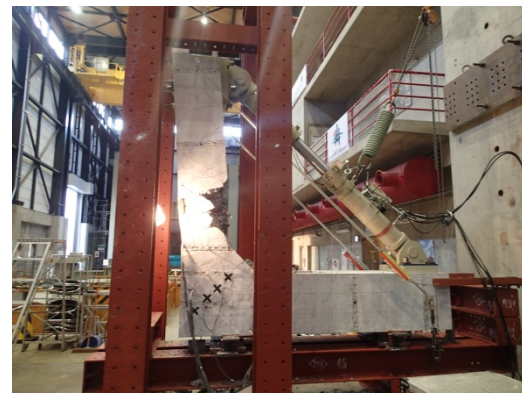
写真-2 実験終了時のユニット型試験体
