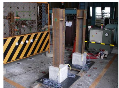
(c) 早強コンクリート打込・硬化後
