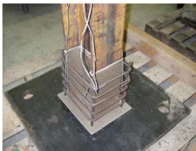
(b) PCM 硬化後・配筋設置
