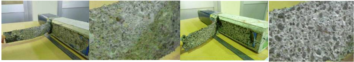
(1) 普通コンクリート供試体の剥離破壊状況
