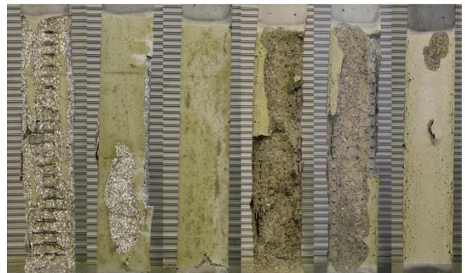
写真-1 载荷加熱実験終了後の試験体状況
