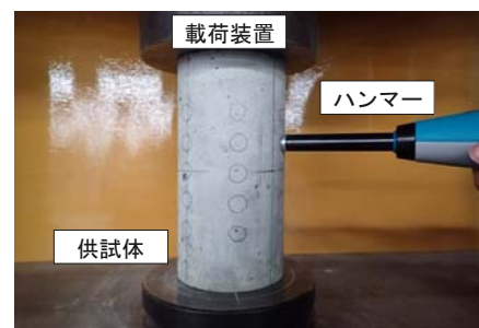
写真-2 反発速度比の測定状況
