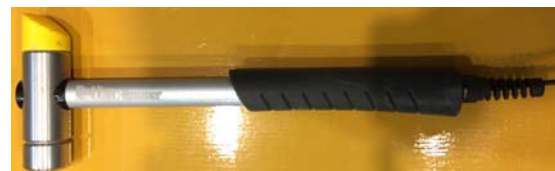
写真-3 機械インピーダンスを測定するハンマー
