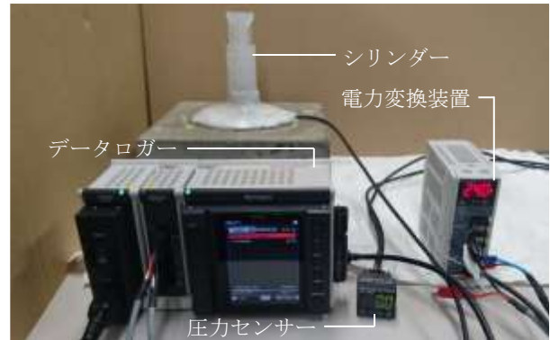
写真-2 圧力測定の様子
