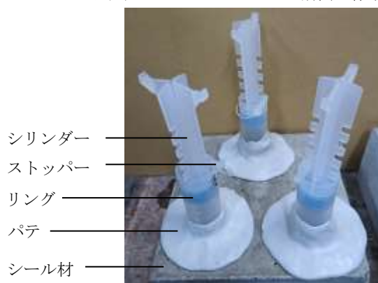
写真-1 試験装置および測定の様子
