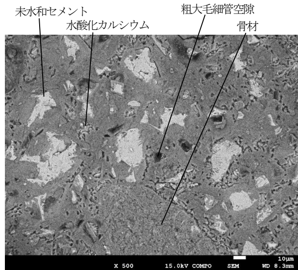
写真-3 基準セメントモルタルの反射電子像の例
