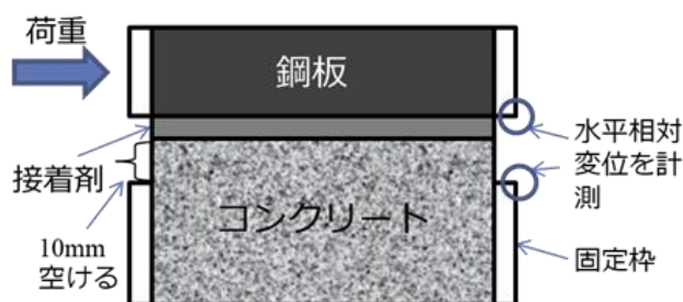
図-3 せん断疲労試験の概要
