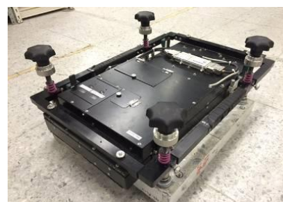
写真-2 ラインセンサタイプ全視野ひずみ計測装置
