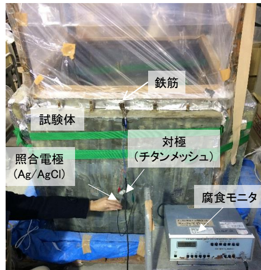
写真-3 大型試験体の自然電位の測定状況
