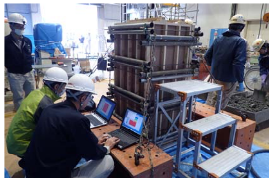
写真-4 無筋構造物による施工実験状況
