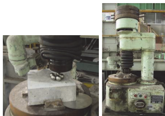
図-2 ボールベアリング式 (BB) 摩耗試験機
