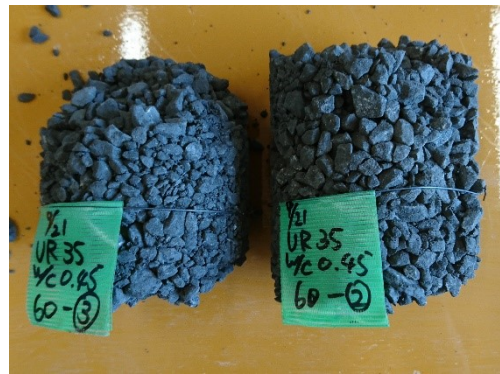
写真-2 骨材の剥落が生じた POC (30°C, VR = 35%, 攪拌時間 60 分)
