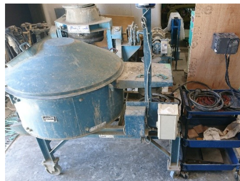
写真-1 フレッシュ POC の攪拌に用いた一軸強制パン型ミキサとインバータ
