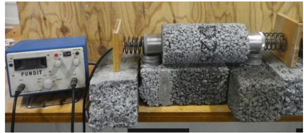
写真-2 超音波伝播速度の測定の様子
