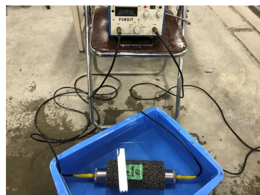
写真-4 水中の超音波伝播速度の測定の様子
