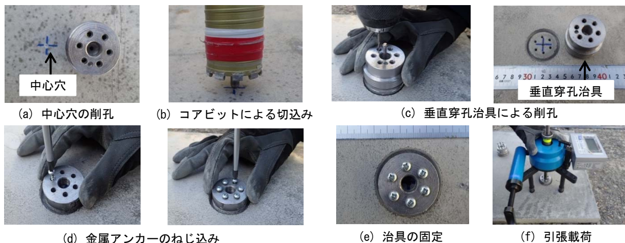
図-2 アンカー治具試験の手順
