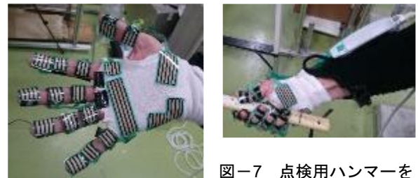
図-6 センサシート装着 図-7 点検用ハンマーを握った時の様子
